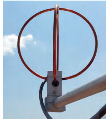
Fig. 24 - Sensor-Antena de campo LINET.
